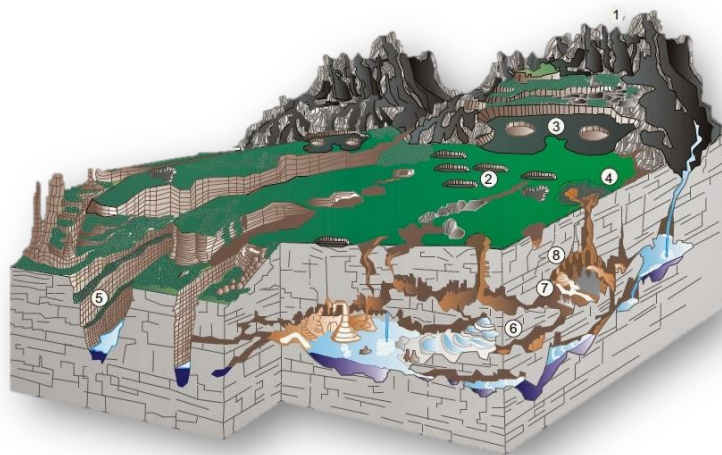
Figura 14. Modelo de un acuífero kárstico. 1.-Lapiaz, 2.- Dolina, 3.- Polje con sumidero, 4.-Sima, 5.-Cañon, 6.-Gours, 7.-Estalactita, 8.- Estalagmita. Fuente: Mateos y González (2009) 30 .
